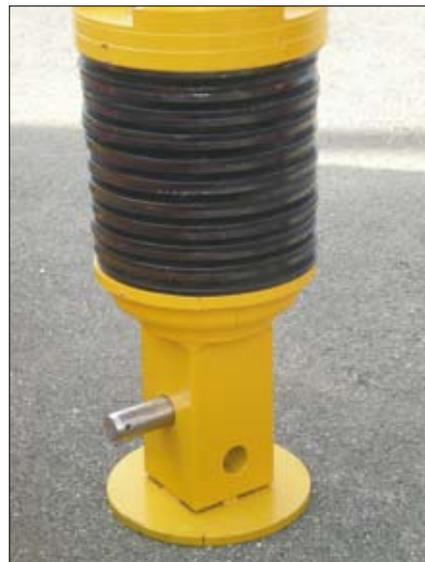
Da sx: particolare dei giunti terminali; attacco quadro in acciaio forgiato; sistema ammortizzante inferiore con molla a dischi in acciaio armonico
